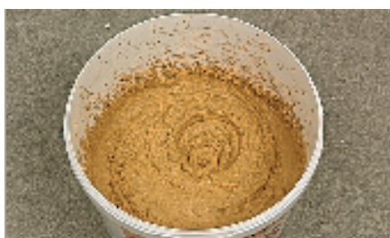
Na 30 minuten nogmaals goed mengen. De foto laat de juiste consistentie zien.
